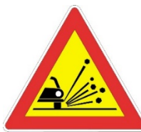
390.31 MATERIALE INSTABILE SULLA STRADA
