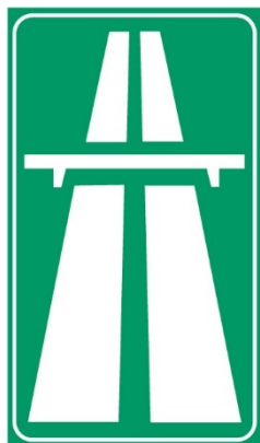
345.135 INIZIO AUTOSTRADA (colore sf. verde) INIZIO STRADA EXTRAURBANA PRINCIPALE (colore sfondo blu)
