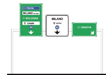
SEGNALI DI CORSIA CON FUNZIONE DI DIREZIONE CON LE MODALITA' PER L'UTILIZZO DELLE SINGOLE CORSIE 252.128
